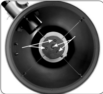
Рис. 31b: Четыре юстировочных винта на корпусе вторичного зеркала
