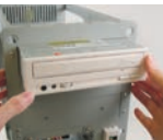
Optikai meghajtó beszerelése
