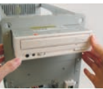
Installazione di un'unità ottica
