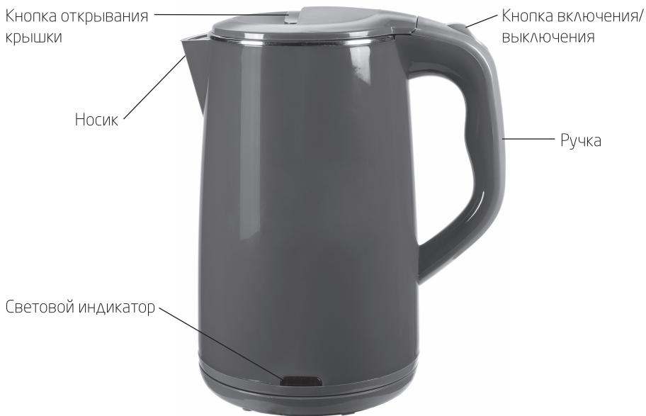
Корпус чайника двойной. Внутренняя его часть и нижняя часть крышки сделаны из нержавеющей стали. Снаружи корпус и крышка пластиковые. Такая конструкция полностью исключает контакт пластика с водой, вместе с тем наружная пластиковая поверхность не нагревается, и об нее нельзя обжечься.
