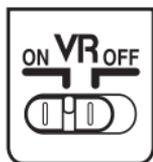
选择**ON**启用减震。减震将在您半按快门释放按钮时激活，从而减少照相机震动的影响以改善构图和对焦。
