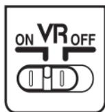
**Sélectionnez ON (ACTIVÉ) pour activer la réduction de vibration.** La réduction de vibration est activée lorsque vous appuyez à mi-course sur le déclencheur, réduisant ainsi les effets du bougé d'appareil pour vous permettre d'améliorer le cadrage et la mise au point.
