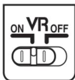
**ON**：シャッターボタンを半押しすると、手ブレを補正します。ファインダー像のブレも補正するため、ピント合わせが容易で、フレーミングしやすくなります。
