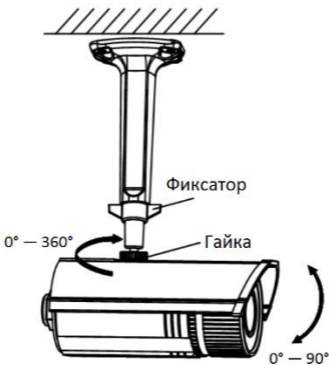
Рисунок 2-9 Настройка угла наблюдения
