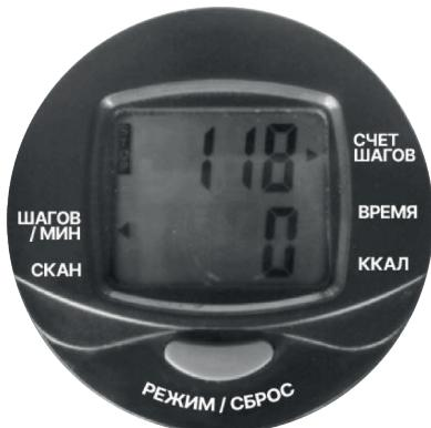
Стрелка на экране указывает на отображаемый в данный момент параметр.
