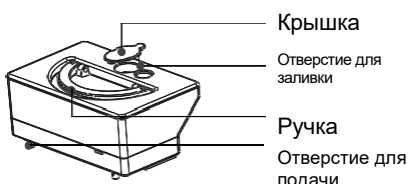
(Резервуар для воды)
