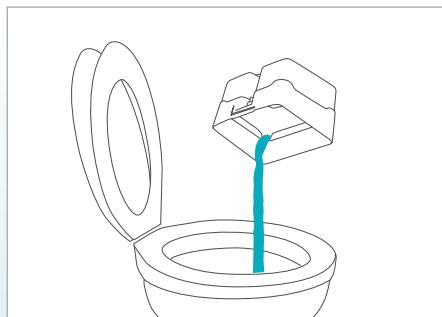
Прежде, чем повторно наполнить резервуар для чистой воды, как это описано выше, необходимо опорожнить/очистить резервуар для грязной воды аквафильтра (см. гл. «Очистка», раздел «Очистка аквафильтра в случае легкого загрязнения»).
