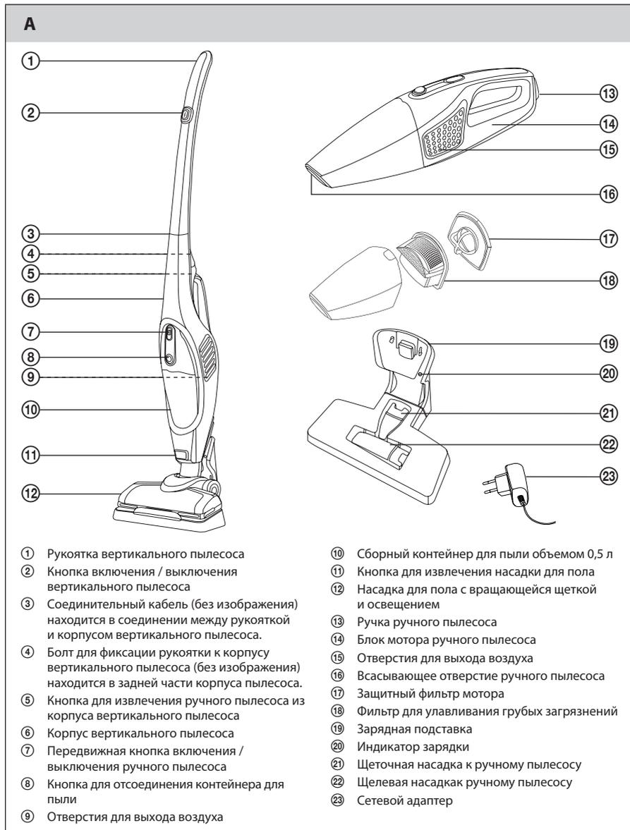
**СБОРКА И РАЗБОРКА ПЫЛЕСОСА И ЗАРЯДНОЙ ПОДСТАВКИ****1. Сборка и разборка ручного пылесоса**
