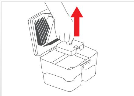
Если в резервуаре для грязной воды аквафильтра еще имеется грязь, то тщательно очистить под струей воды и вылить грязную воду через сливное отверстие.
