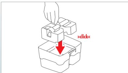
Установить вставку для защиты от разбрызгивания в резервуар для грязной воды, не извлекая всасывающий фильтр.
