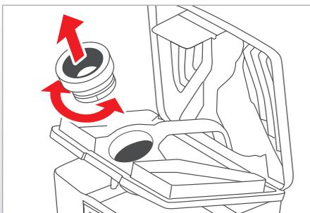
При сильном загрязнении так называемый инжектор можно снять в целях очистки, вращая уплотнение патрубка.
